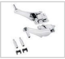
F. ADJUSTABLE AUXILIARY PASSENGER FOOTPEG MOUNTS - REAR POSITION
