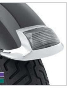
C. LED FENDER TIP LENS - SMOKED FRONT FENDER
