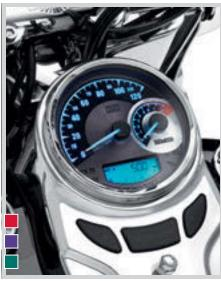
A. COMBINATION ANALOG SPEEDOMETER/TACHOMETER - 5" SPUN ALUMINUM DIAL
