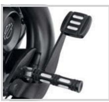
B. EDGE CUT COLLECTION BRAKE PEDAL PAD AND FOOTPEGS
