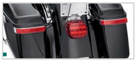
A. ELECTRA GLO LED SADDLEBAG RUN/BRAKE/TURN LAMP
